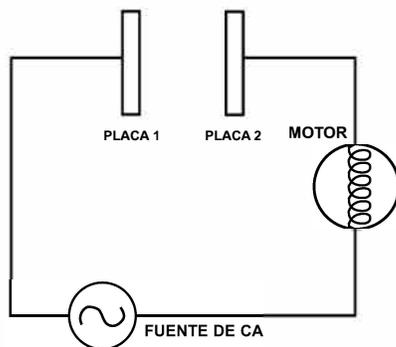
Ahora, conectemos nuestro condensador simple a una fuente de corriente alterna y en serie con los devanados de un motor eléctrico. Ya que la corriente alterna se alterna, primero una placa y luego la otra, se cargará y descargará a su vez.
