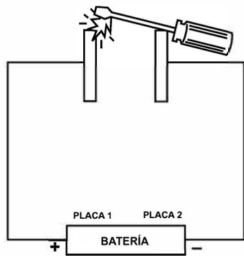
Si provocáramos un corto circuito a través de las placas con un destornillador, la chispa resultante señalaría a los electrones "saltando" de la placa 2 a la placa 1 en un intento por igualarse. Tan pronto se retire el destornillador, la placa 1 recolectará de nuevo una carga.
