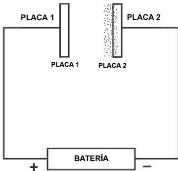
Un condensador muy simple se puede hacer con dos placas separadas por un dieléctrico, en este caso aire, y conectadas a una fuente de corriente directa, una batería. Los electrones fluirán de la placa 1 y se recolectarán en la placa 2, dejándola con una abundancia de electrones o una "carga". Ya que la corriente de una batería fluye solamente en una vía, la placa del condensador permanecerá cargada de esta manera a menos que algo haga que la corriente fluya.
